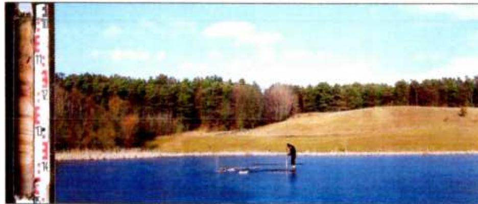
Bohrkern zwischen 7,0 und 25 m unter der Eisoberkante, geschichtete Sedimentablagerungen | Foto: N. Schlaak
